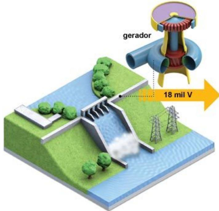
**Estação geradora** A energia elétrica pode vir de diferentes fontes. Nas hidrelétricas, a queda-d'água movimenta um gerador, que cria um campo magnético, produzindo corrente elétrica.
