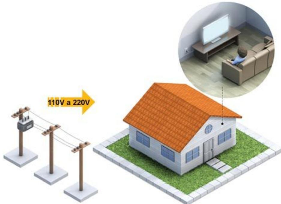
**Fiação dos postes** A energia passa pelos transformadores de distribuição, que rebaixam a voltagem de novo. Depois, passa pela fiação - aérea ou subterrânea -, que a leva até as ruas.
